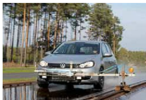
Brzdná dráha na mokré vozovce se u nejhorší a nejlepší testované pneumatiky lišila o 22 metrů.
